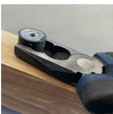
2) Schrauben Sie den defekten Klotz von Hand oder mit einer Zange ab. Da das Gewinde des Klotzes mit Zementkleber beschichtet ist, muss man etwas Kraft aufwenden.
