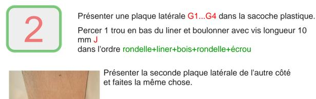
dans l'ordre rondelle+liner+bois+rondelle+écrou Présenter la seconde plaque latérale de l'autre côté et faites la même chose.
